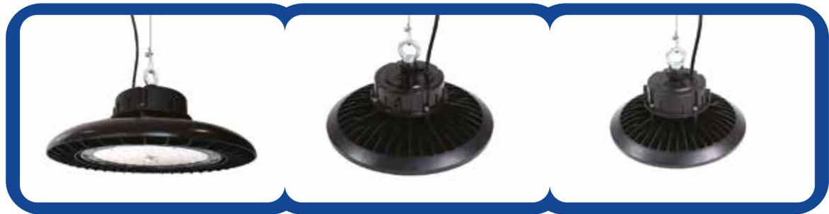
**CUERPO:** Inyección de aluminio **DIFUSOR:** Policarbonato inyectado transparente **DRIVER:** Incorporado en la luminaria y cuenta con protección de línea (DM-4kV y CM-6kV), sobre temperatura, cortocircuito y circuito abierto **VIDA ÚTIL:** 50000 hs.
